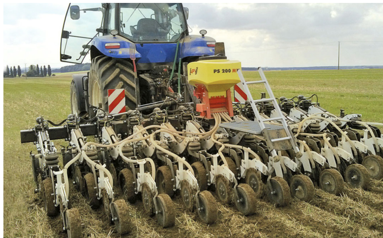
12 file 45 cm con elementi di semina per la semina della colza
