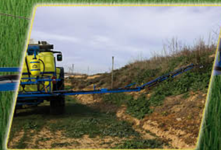
Demi géométrie variable pour une application parfaite sur des parcelles accidentées.
