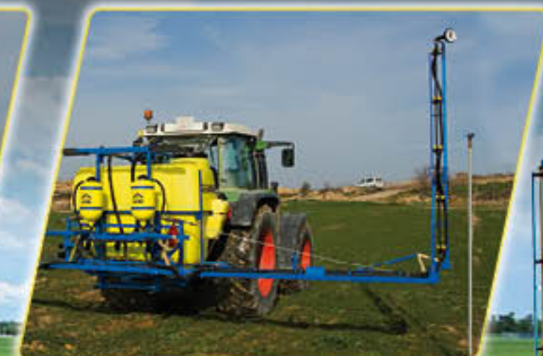
Repliage indépendant des sections d'extrémités pour éviter un obstacle et continuer le traitement avec le reste de la rampe
