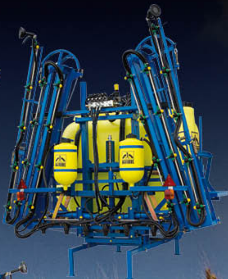
Pulvérisateur 1500 l avec cuve de rinçage intégrée et lave mains d'origine Pompe membranes 20/135 l/min Rampe 13 m. Type C D.P.M. origine
