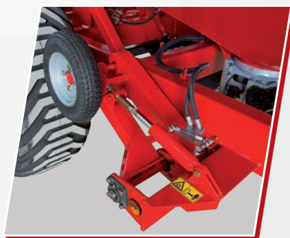
Azionamento del dosatore con ruotino o con ELETTRO-DRIVE
