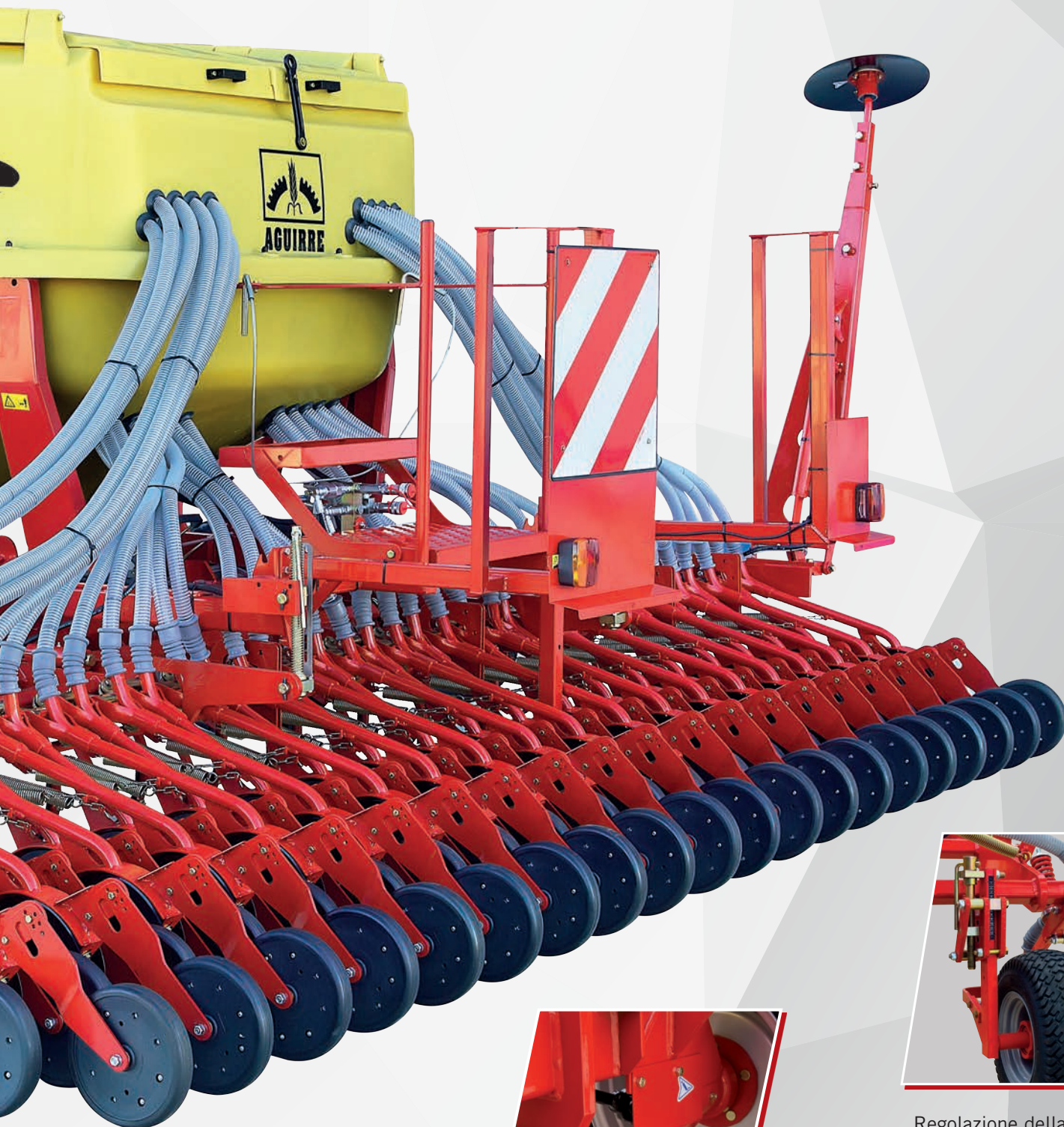
Regolazione della profondità di semina mediante le ruote livellanti
